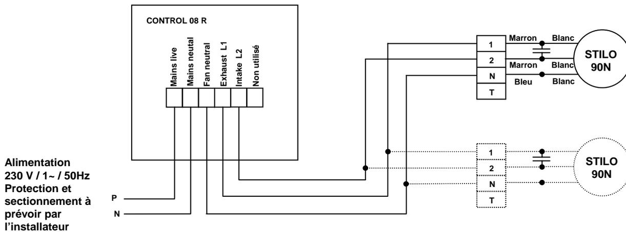
**Nota :** raccordement prévu sur l'arrière, fil souple 0.75 mm<sup>2</sup> conseillé.
